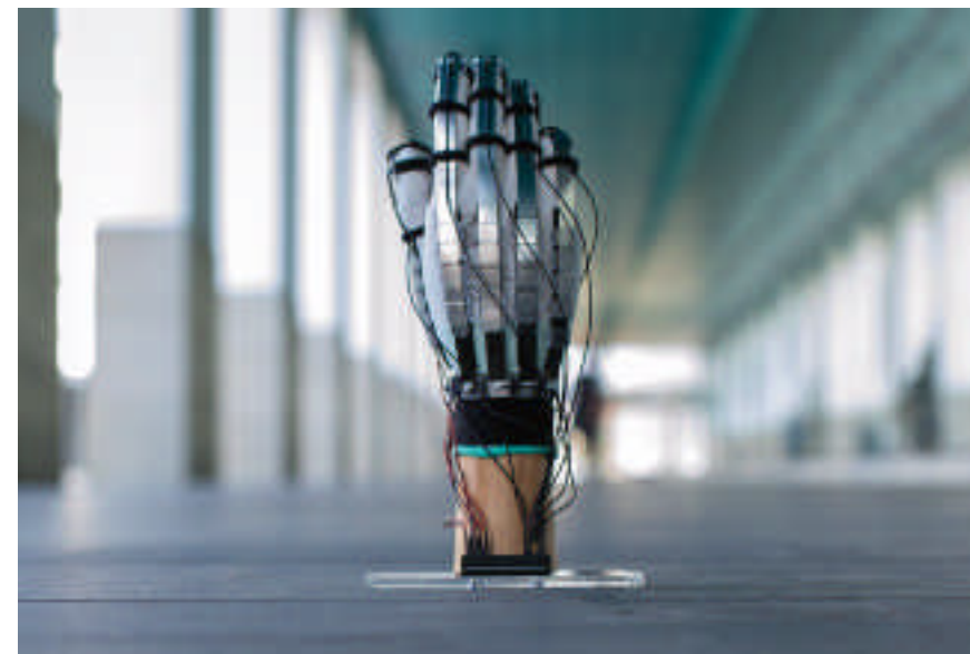
Der haptische Handschuh wird zurzeit noch über ein sehr dünnes elektrisches Kabel mit Strom versorgt.
