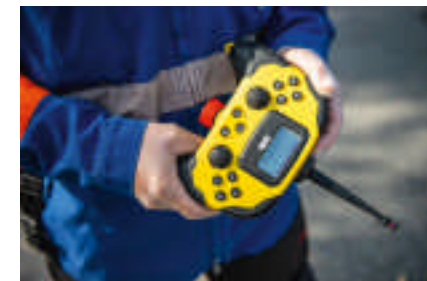
Zur Sicherheit wird der Roboter bei seinen ersten Schritten teilweise mit dem Joystick gesteuert, bevor er autonom agiert.
