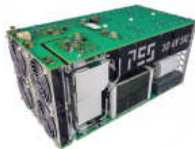
Der Mittelspannungskonverter ist ein Teil des neuen smarten Transformators.
